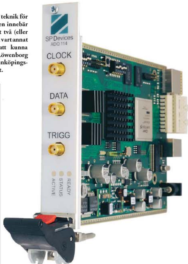
Fig 7. SP Devices datainsamlingskort ADQ114 uppvisar hittills överträffade prestanda: 800 MSa/s och 14 bitar. Kortet är bestyckat med en FPGA, där kunden kan lägga applikationsspecifik signalbehandling, och en FPGA, förprogrammerad med felkorrigeringsalgoritmen. Kortet är bestyckat med kontaktdon för höghastighetskommunikation antingen via Compact PCI Express eller USB2.
